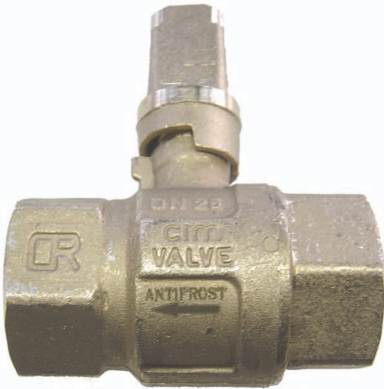
Kule med ekspansjonshull. Pilen viser ekspansjonsretning, ved stengt ventil.
